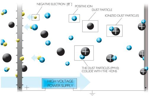
THE POSITIVELY CHARGED CORONA ELECTRODE ATTRACTS THE ELECTRONS THE GROUNDED COLLECTOR ELECTRODE ATTRACTS THE POSITIVE CHARGED IONS
